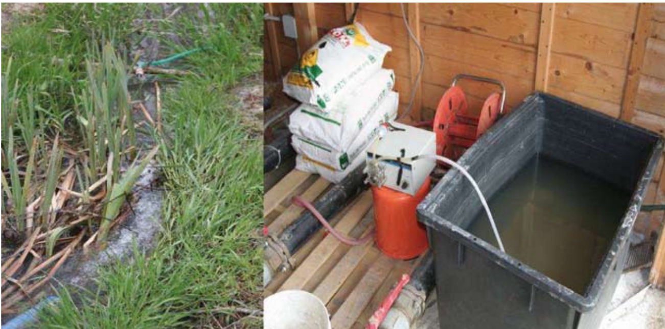
Figura 32. A sinistra: l'immissione della soluzione ad alta concentrazione di azoto nella scolina adacquatrice coincide con la fase di funzionamento delle pompe di irrigazione. A destra: la pompa peristaltica preleva l'acqua dalla vasca di diluizione.
