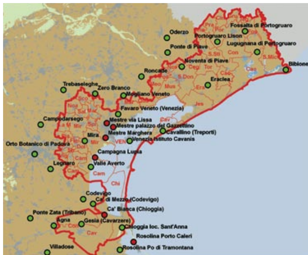
Figura1: stazioni di misura pluviometriche utili per lo studio delle precipitazioni sul territorio della provincia di Venezia. In verde le stazioni attualmente attive, in rosso quelle dismesse.
